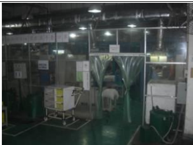
电镀车间照片(地面全部采用FRP防腐处理)
