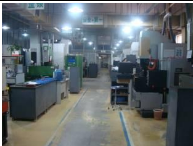
电镀车间照片(地面全部采用FRP防腐处理)
